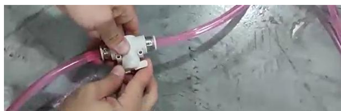
Abbildung 9 Einlassventil zur Durchflussregulierung
